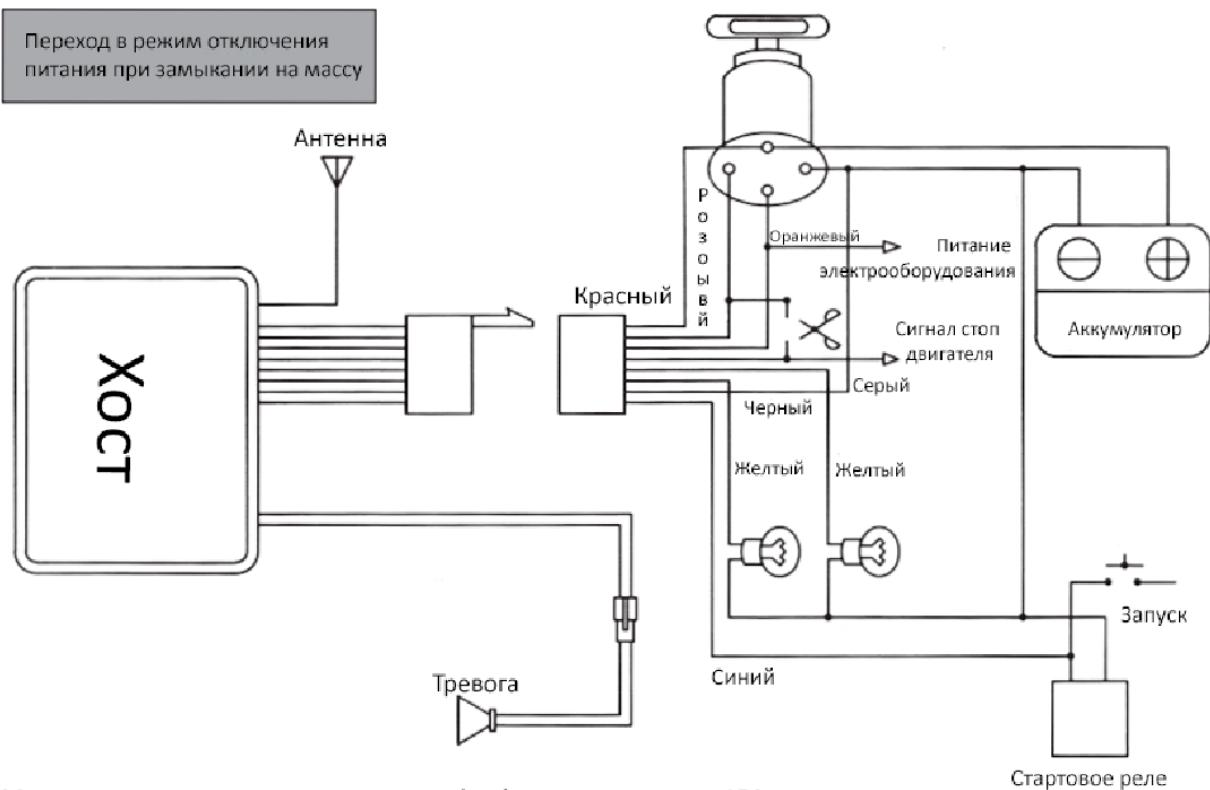
Максимальная подключаемая нагрузка (ток) по реле стартера: 15A.
