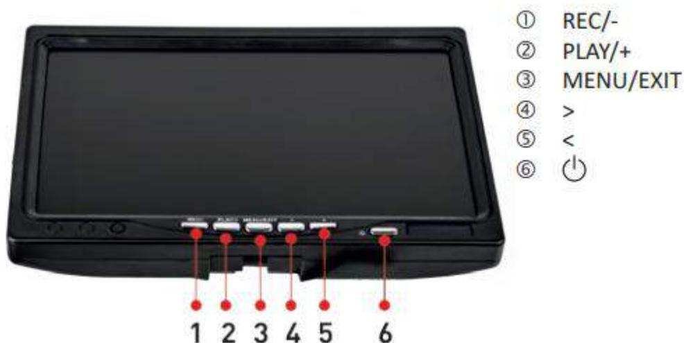
1. REC/-: включение/выключение режима записи, уменьшение числового значения параметра.
